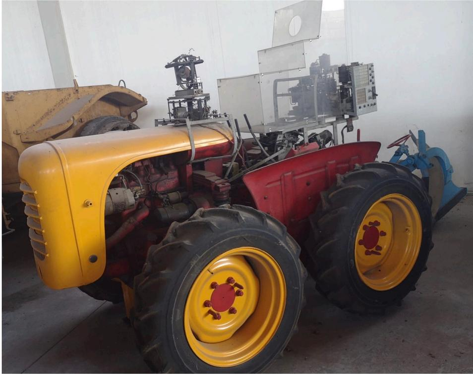
Trattrice BOPS/60 a guida programmata (esempio di trattrice “robot” a guida autonoma). Fonte: Università di Bologna-Laboratorio di Meccanica agraria - raccolta storica di macchine agricole
